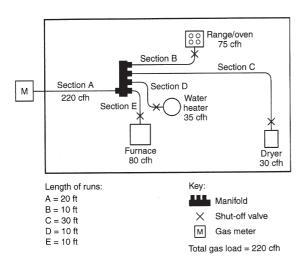
FIGURE C-A.7.3 PIPING PLAN SHOWING A COPPER TUBING SYSTEM
